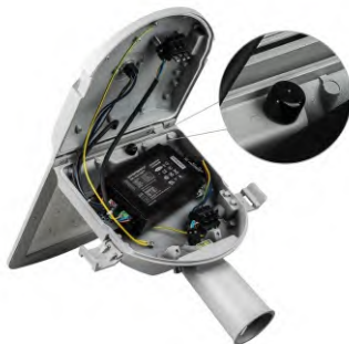
Клапан выравнивания давления. Предназначен для защиты светильника от возникновения внутри него конденсата и избыточного давления.
